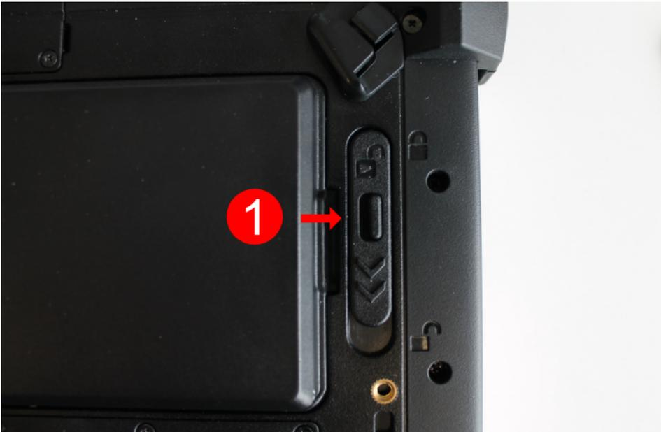
2. Stellen Sie sicher, dass der Verriegelungsmechanismus (Nummer 1 im Bedienungs- und Anzeigeelemente-Schaubild) auf entriegelt steht. Sie erkennen dies daran, dass der Schieberegler näher beim Symbol „geöffnetes Schloss“ ist als „verriegeltes Schloss“.
