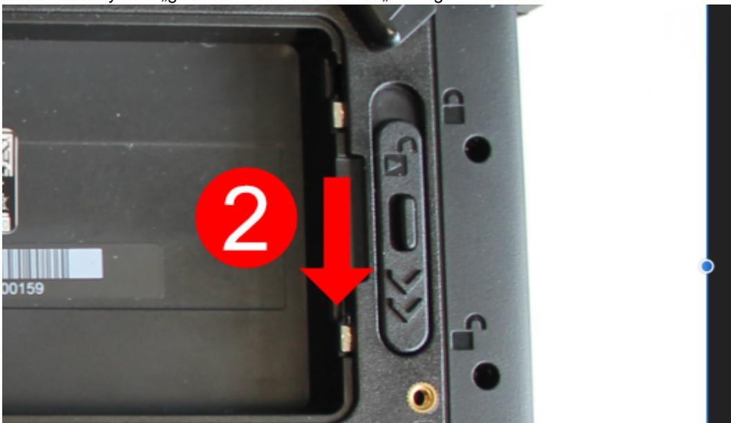
3. Legen Sie nun den Akku wie angezeigt ein. Achten Sie darauf, dass die Kontakte des Akkus auf der richtigen Seite des Geräts sind
