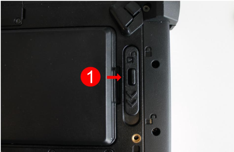
2. Stellen Sie sicher, dass der Verriegelungsmechanismus (Nummer 1 im Bedienungs- und Anzeigeelemente-Schaubild) auf entriegelt steht. Sie erkennen dies daran, dass der Schieberegler näher beim Symbol „geöffnetes Schloss“ ist als „verriegeltes Schloss“.
