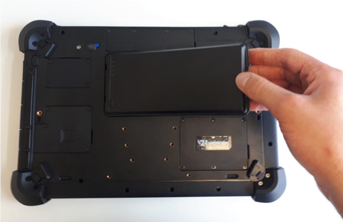
4. Verriegeln Sie abschließen den Verriegelungsmechanismus und Verschließen die Sicherung.
