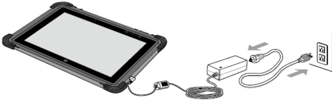
Wenn der Netzadapter angeschlossen ist, beginnt der Akku zu laden. Die Akku-LED Anzeige am Tablet Computer zeigt verschiedene Zustände an. Bitte beachten Sie die [Beschreibung](#) der LED-Anzeige.
