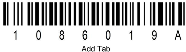
**Add Tab:** Wenn diese Option aktiviert ist, fügt der Barcodescanner nach dem Scannen eines Barcodes einen Tabulator hinzu. Dies entspricht dem Drücken der "Tab"-Taste auf einer Tastatur. Die gescannten Daten werden in einer einzigen Zeile belassen, wobei zwischen den einzelnen gescannten Daten ein Tabulator eingefügt wird.
